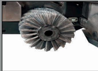
Robusta con un gran cepillo central de 300 mm de diámetro, autonivelante con presión regulable y rotación en sentido contrario a las agujas del reloj.
